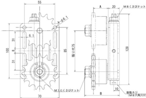
KANAストレートテンションは M10・M8 くさびナットを緩めて移動ネジ(M8六角穴付)を回し、緩めたくさびナットを締め付け固定する事で、最大75mmの張り代が調整できます。(くさびナットの性能は、P.394をご参照ください)また、付属のスプロケットホイールを取り外しプーリーを取付けることで、ベルト用テンション等ローラーチェーン以外の緊張装置としてもご利用いただけます。
