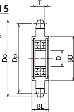
KANA標準SUS(ステンレス)アイドラー sprocketは、ローラチェーンの伝動に於いて適切なテンションを保持いたします。ステンレス鋼にて作製されており、耐腐食性、耐久性に優れています。ステンレス製ベアリングはスプロケットの中心に位置しています。
