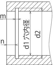
KANA標準アイドーラスプロケットに挿入されている専用スナップリングです。KANA標準ベアリングを正確に固定していただけます。
