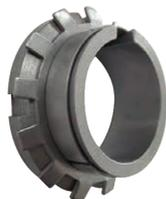
KPL250形は取付けスペースが最小ですむので、締付けナット1個で取付けできます。ほかにパーツを必要とせず、軸方向にC形スパナ用のスペースを設ける必要もありません。ボス穴とシャフトの嵌合は、H8/h8までです。
