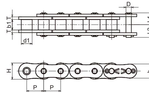
KANAスーパーローラチェーンはプレートの外形を標準ローラチェーンより一回り大きくし、ピンを強靱鋼にて製作することで、平均引張強さ・最大許容張力を高めたチェーンです。
