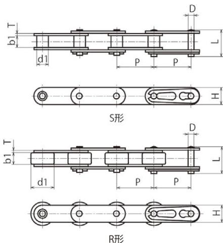
チェーンピッチが2倍で、プレートの形状がフラットになっています。ローラ形式にはSローラとRローラがあり、小型コンベヤチェーンとして破断強度が高く耐久摩耗性に優れています。専用スプロケットをご使用ください。
