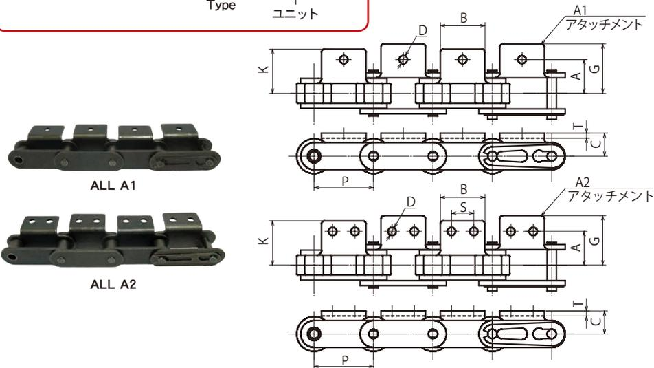
KCM ニバイピッチローラチェーンは、伝動用ローラチェーンのピッチを2倍にしたチェーンです。各部はローラチェーンと同じ仕様で小形コンベヤチェーンとして破断強度が高く耐久摩擦性にも優れたチェーンです。ローラにはR形とS形があり、またアタッチメント付チェーンにはA1・A2/K1-K2があります。
