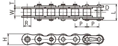
標準形ローラチェーンのリンクプレートを厚くするとともに、ピンに強靱鋼を採用してANSIのHタイプよりも強度を高めたチェーンです。
