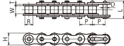
オイルレスチェーンは、鉄系焼結合金に油を含浸させたブッシュを使用し、長時間の無給油運転が可能です。このため給油のできないところでの使用に最適なチェーンといえます。しかも標準ローラチェーンとの寸法互換性があります。
